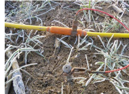
Implantation des électrodes dans le sol (tous les 10 m)
