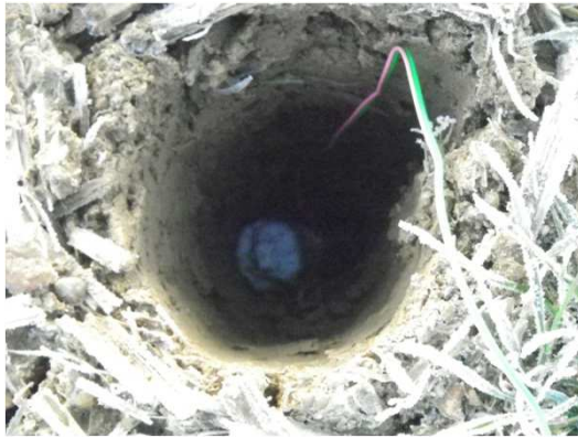
Trou avec bâton de dynamite (tous les 10 m)
