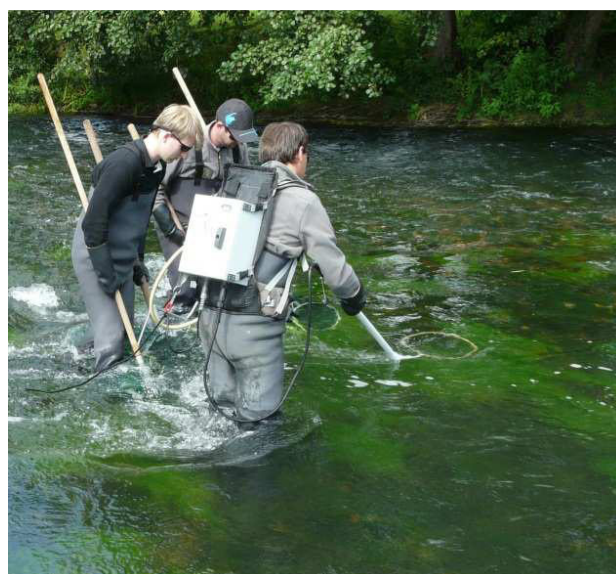
Figure 2 : Matériel de pêche électrique portatif de type « MARTIN PÊCHEUR »
